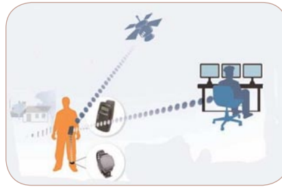
Dispositif technique (satellite, récepteur portable, bracelet, centre de contrôle)
